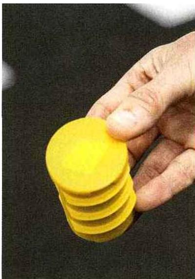
Long de 13 cm et de 5 cm de diamètre, le capteur développé par Colas s'intègre directement dans la chaussée.
